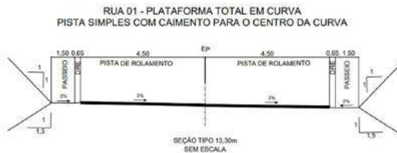
Figura 5 - Seção Tipo 13,30 - Plataforma total em curva
